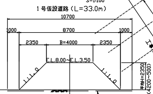
仮設道路工 標準断面図 S=1:100
