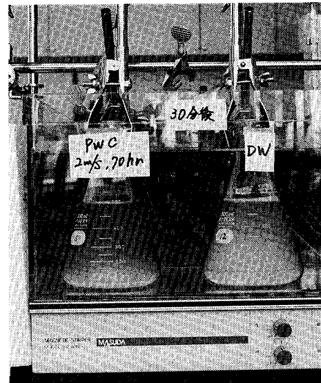
写真1 カオリン懸濁液沈降試験 PWC: ポーラ・ウォーター・コンディショナーにより70時間磁気処理 DW: 無処理の水道水 Photo. 1 Sedimentation test of kaolin suspension. PWC: magnetic treatment water by Polar Water Conditioner for 70 hours DW: tap water (control)
