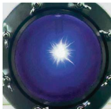
写真1 パルス放電時の発光（水道水中）
