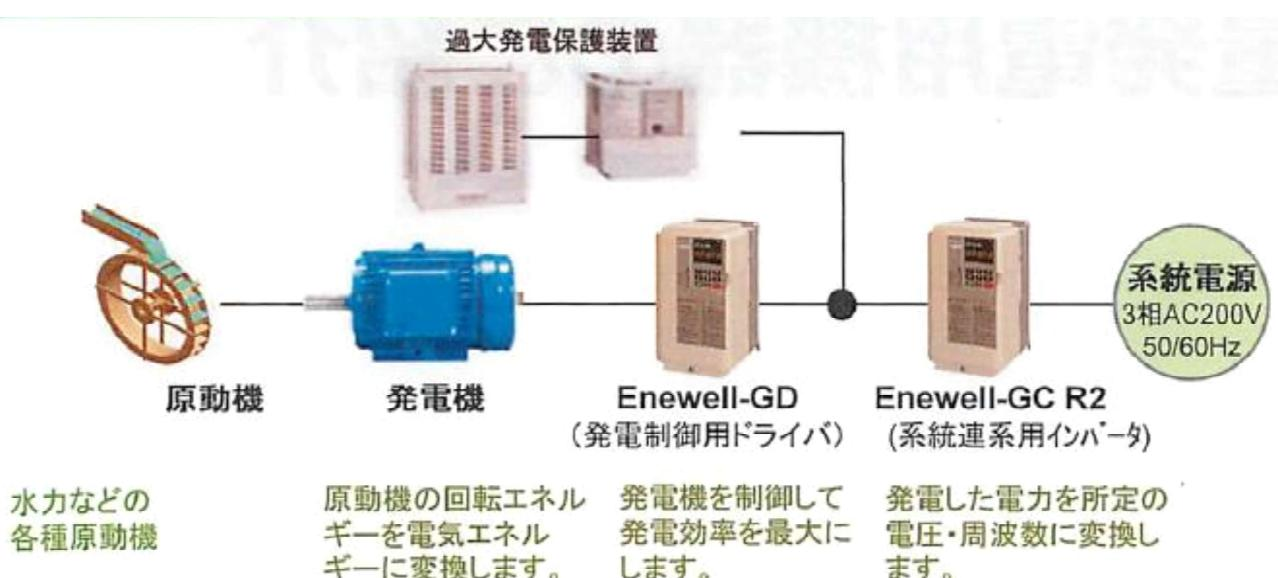
図-13 系統連系の電気システム<sup>2)</sup>
