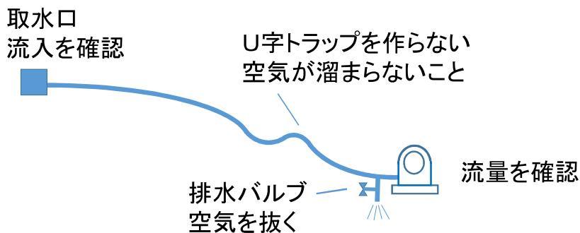
図-38 配管路の空気抜き
