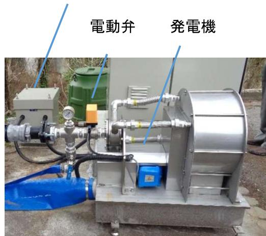
図-43 発電装置と直流分流防止変圧器
