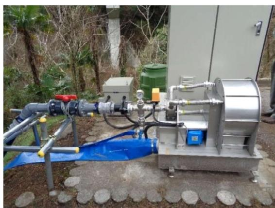
図-35 ペルトン式水車の外観
