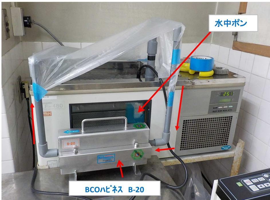
純水42ℓ 低温恒温水槽(ADVANTC LF-480)を使用し、水温25℃の一定条件化で実験。
